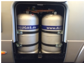
Artikel nr 223 Hållare för tankflaska 11kg o 14kg Godkänd av TÜV
